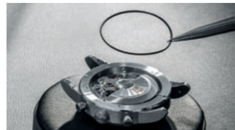
5. Troca das vedações
