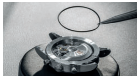
5. パッキン交換
