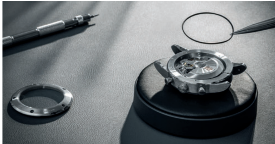
5. Changement du joint d'étanchéité
