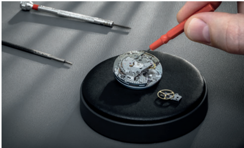
3. Entretien et lubrification du mouvement
