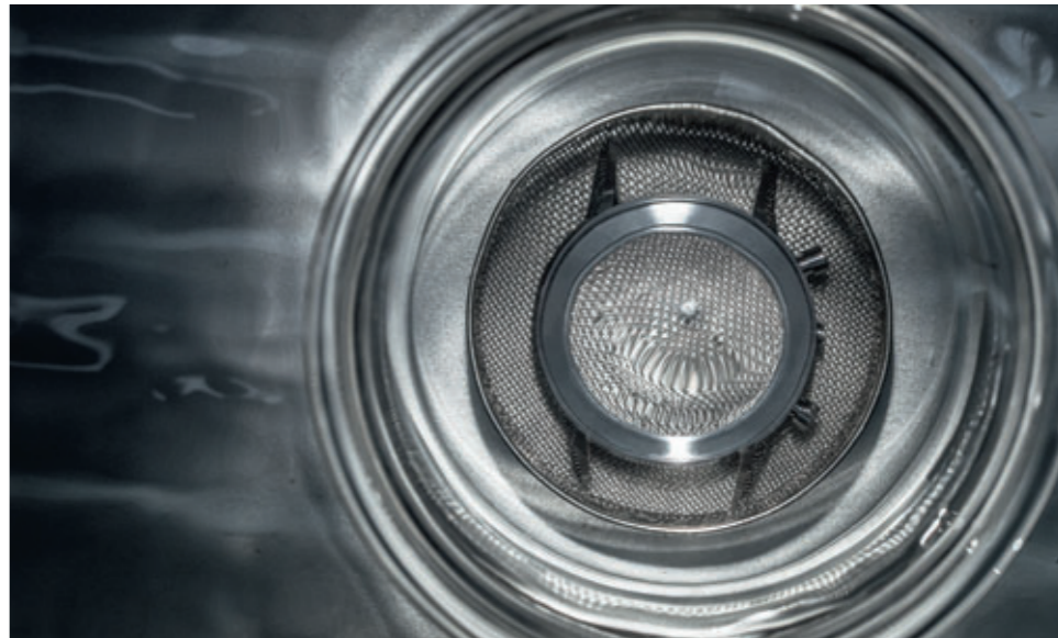
7. ケース、クラスプ、ブレスレット部分の超音波洗浄
