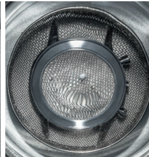
6. Nettoyage à ultrasons du boîtier, du fermoir et du bracelet
