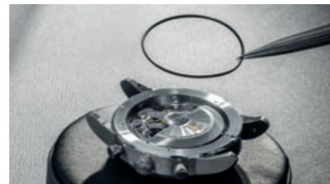
5. Austausch der Dichtungen
