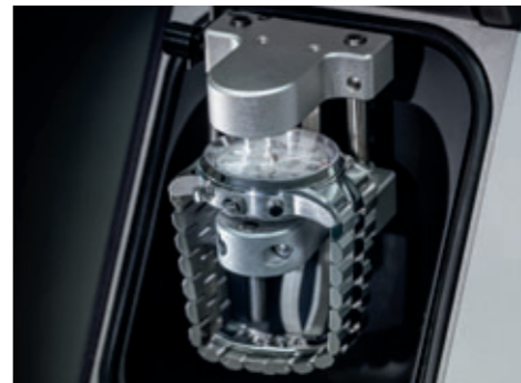
8. Prueba de resistencia al agua o estanqueidad
