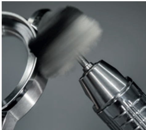
6. Lucidatura della cassa, della chiusura e del bracciale in acciaio
