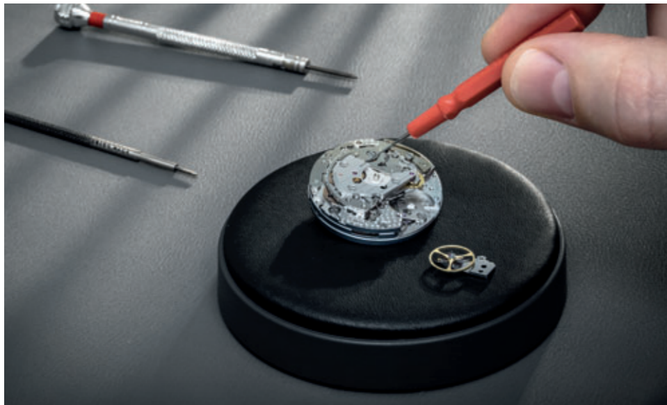
3. Controllo del movimento e lubrificazione
