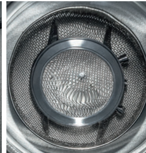
6. Ultraschallreinigung von Gehäuse, SchlieÙe und Armband
