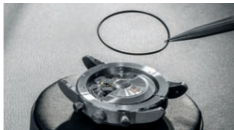
5. Sostituzione della guarnizione
